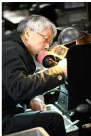
合刃(あいば)工程で、左右の刃をぴったり合わせたら、最終仕上げの刃付け工程です。拡大鏡で刃部を大きく拡大し、爪の形にそってカーブした刃を極限まで薄く研いでいきます。わずかな力加減で品物の良し悪しが決まるため、息もつけない程の集中力が必要です。削り過ぎると絶対に元に戻すことが出来ないギリギリの感覚が要求される作業です。
