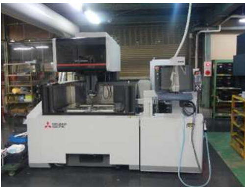
新規で導入したワイヤーカッター 精密な部品作りに利用します
